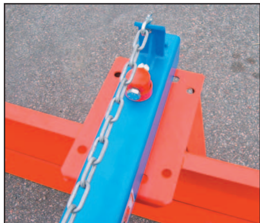
Hål i vändkransen tillåter justering av bladets vinkel
